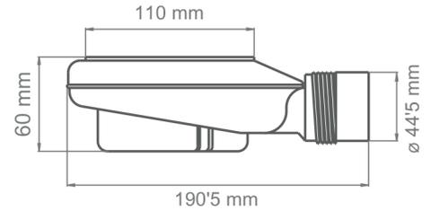
Capacité d'évacuation 58L/min
